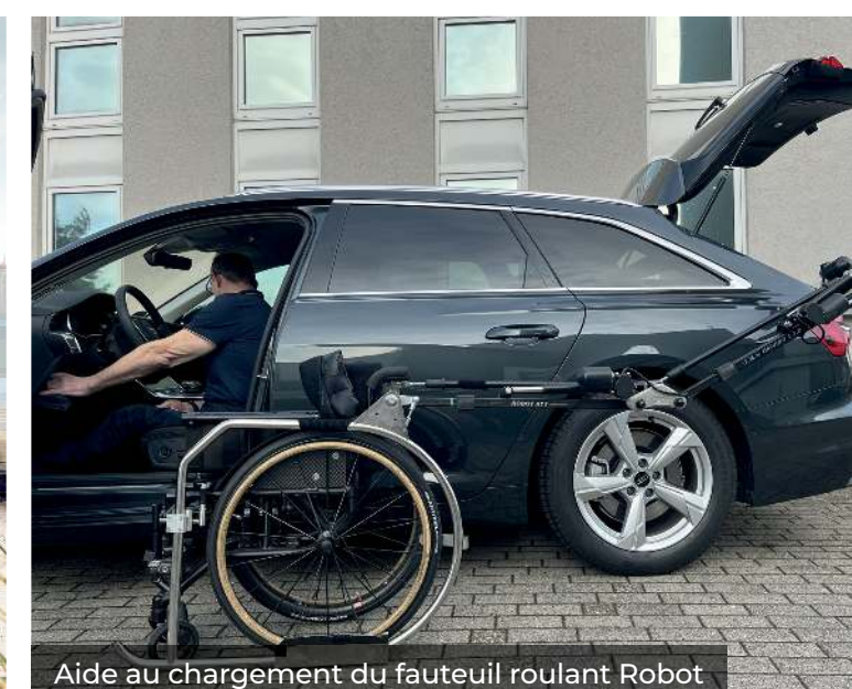
Système de chargement latéral du fauteuil roulant Ladeboy S2
