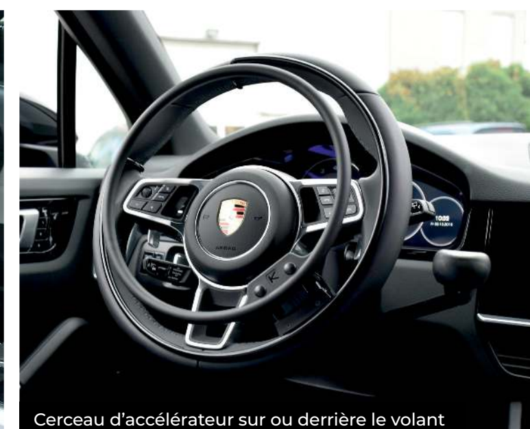
Commande manuelle EasySpeed avec Multikommander Mini II
