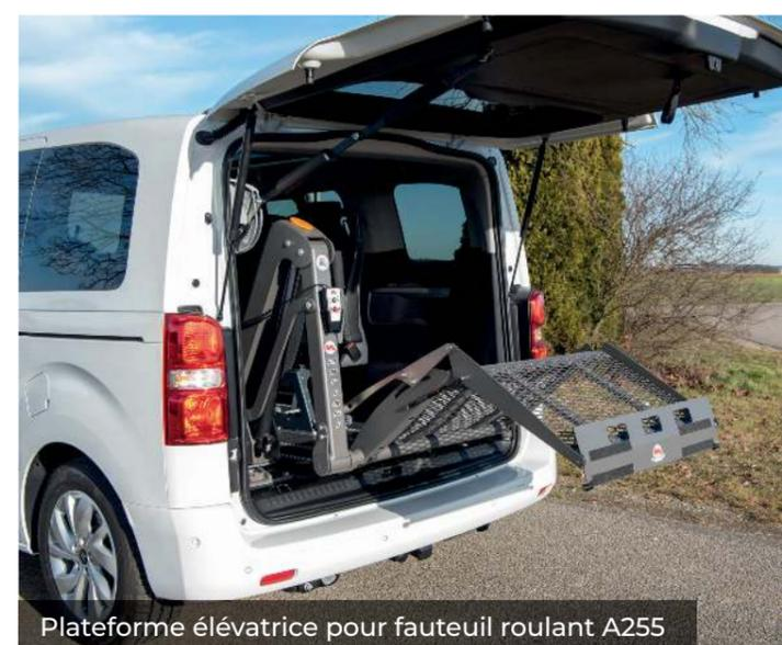
Plateforme élévatrice pour fauteuil roulant A255
