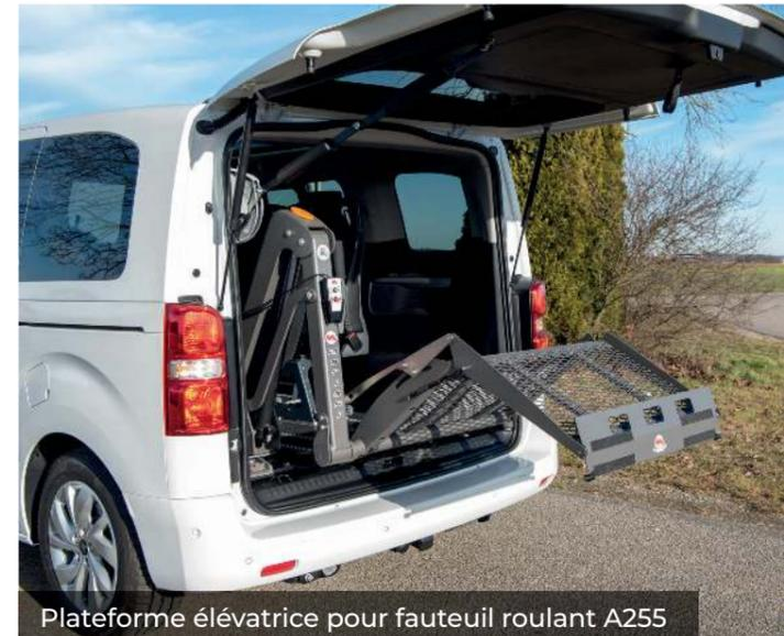
Plateforme élévatrice pour fauteuil roulant A255
