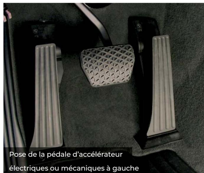
Pose de la pédale d'accélérateur électriques ou mécaniques à gauche
