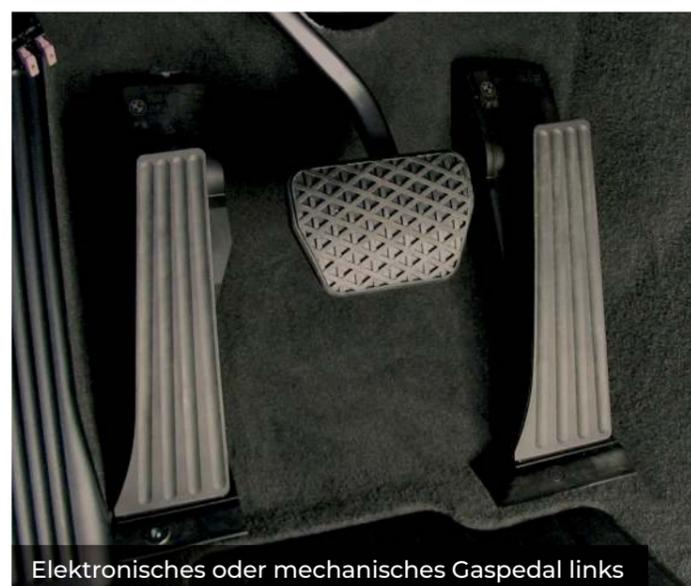
Elektronisches oder mechanisches Gaspedal links
