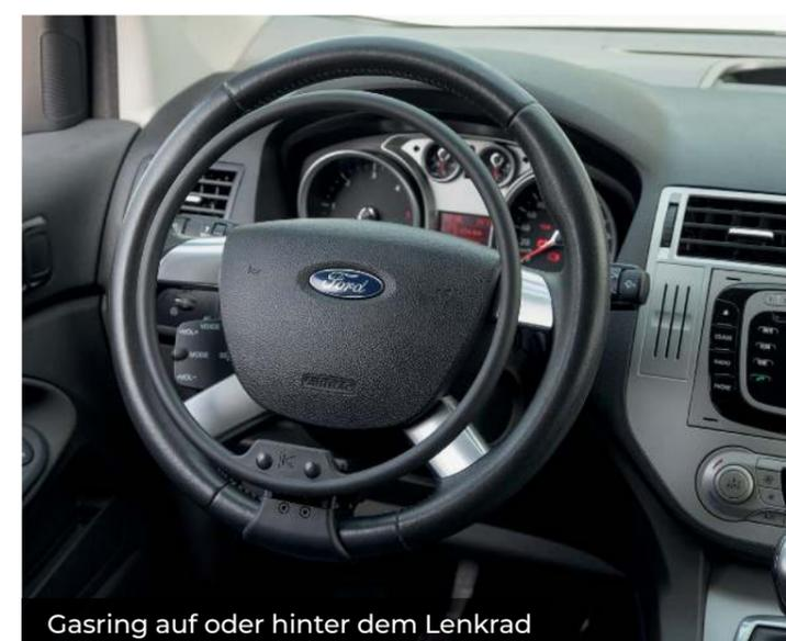
Gasring auf oder hinter dem Lenkrad
