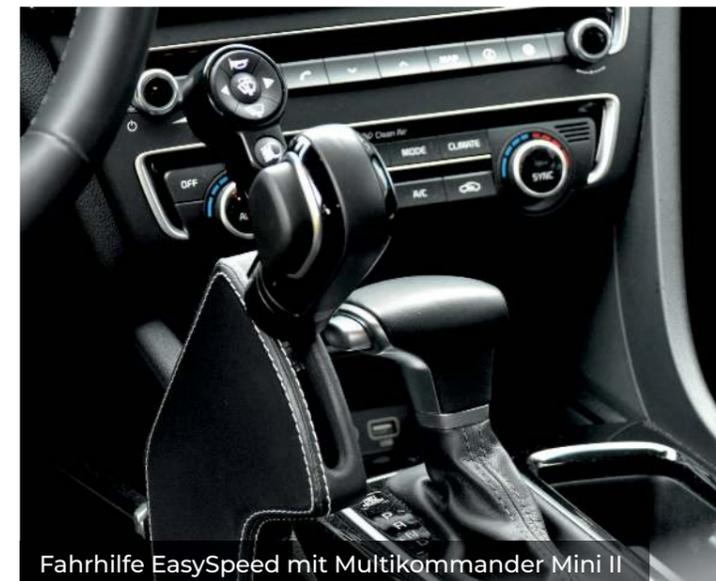
Fahrhilfe EasySpeed mit Multikommander Mini II
