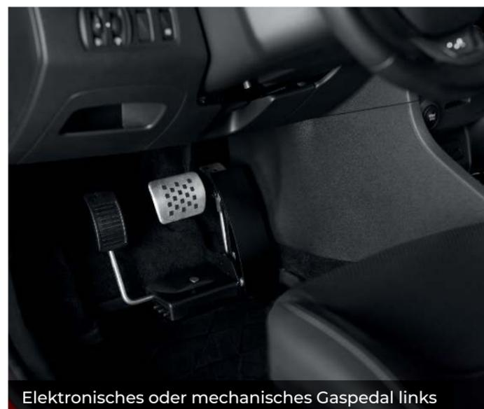
Elektronisches oder mechanisches Gaspedal links
