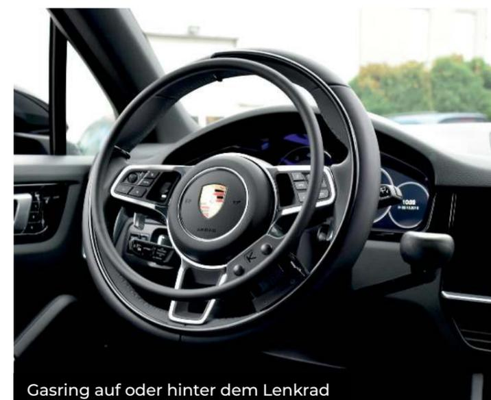
Gasring auf oder hinter dem Lenkrad
