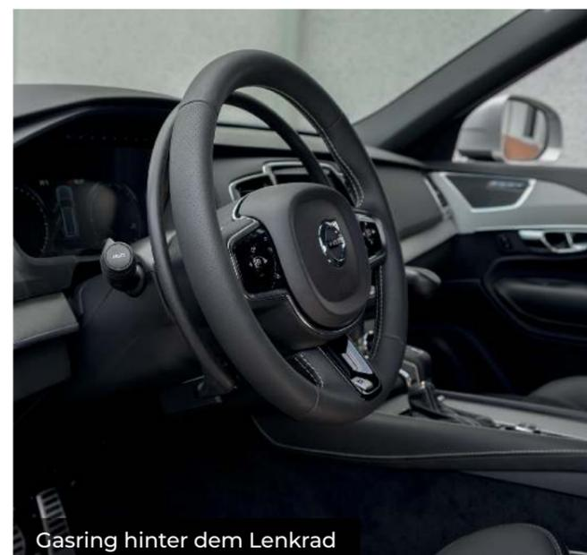
Gasring hinter dem Lenkrad
