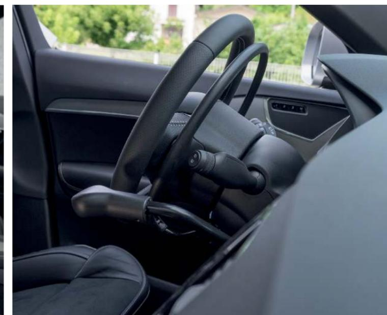
ziehen oder in Richtung Armaturenbrett zu drücken. Der Gasring K6 hingegen beschleunigt, indem er mit dem Handrücken oder Fingern in Richtung Armaturenbrett gedrückt wird.
