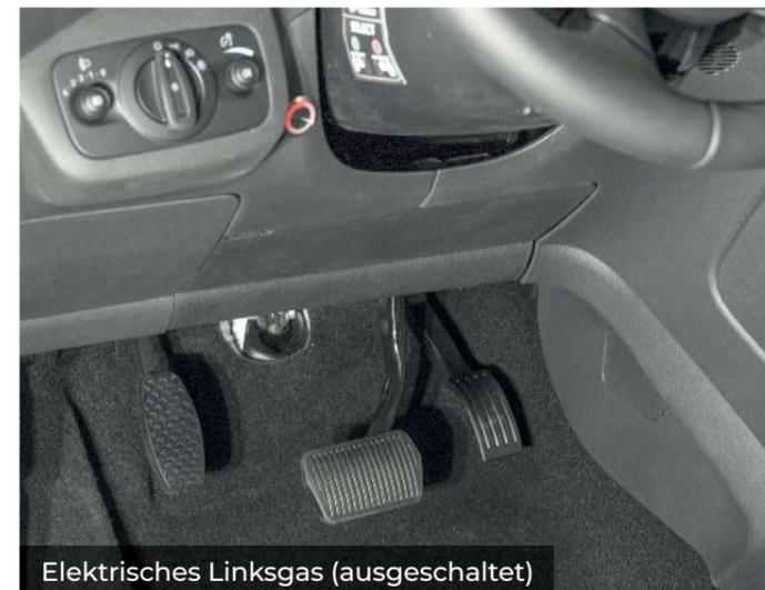
Elektrisches Linksgas (ausgeschaltet)
