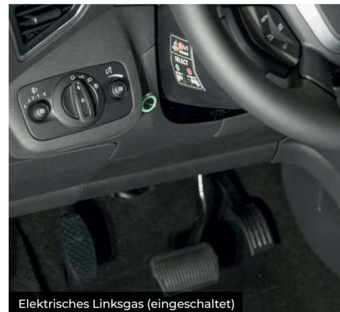
Elektrisches Linksgas (eingeschaltet)
