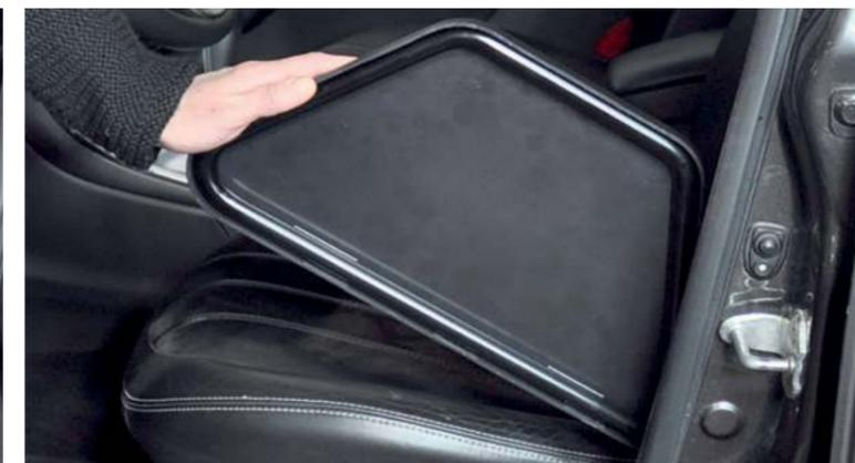
Wenn Ihnen eine fixierte Höhe ausreicht, bietet sich die Umsetzhilfe an. Hier wird die klappbare Sitzfläche, ebenfalls fest an der B-Säule, auf der für Sie passenden Höhe montiert.
